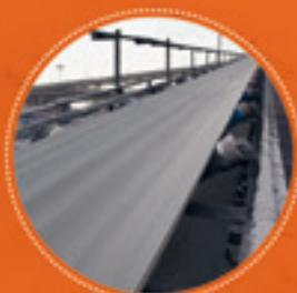
Formada por varias capas de tejidos de poliéster y nylon (EP) protegidas con recubrimiento de caucho de altas prestaciones. Una solución versátil, apta para un amplio rango de trabajos: lisas, nervadas, rugosas, deslizantes, etc.
