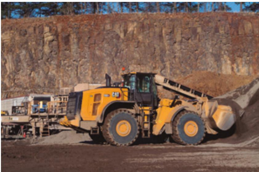
La tecnología Cat Payload ofrece objetivos de carga precisos con pesaje en movimiento, lo que ayuda a prevenir los defectos y excesos de carga y maximiza la eficiencia. Las funciones de pesaje de baja elevación y descarga manual optimizan el proceso final del cucharón y maximizan la eficiencia.
