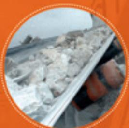
Más resistentes, ligeras y flexibles que sus equivalentes textiles multicapa: ofrecen menos alargamiento, más capacidad de absorción de impactos y refuerzo al desgarrar longitudinal.
