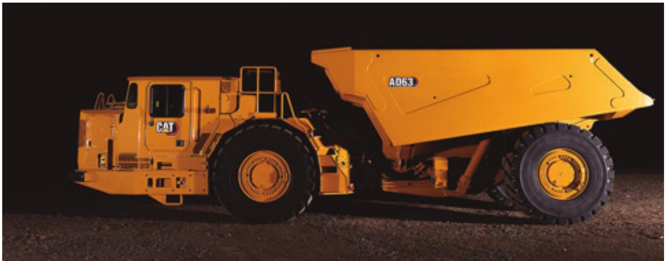
**E**l nuevo dúmpster articulado subterráneo Cat AD63 ofrece un aumento de la carga útil del 5 % y un par mayor para mejorar las capacidades de producción, en comparación con el modelo anterior, el AD60. El nuevo AD63 también puede configurarse conforme a los estándares de emisiones de motores diésel más estrictos, tanto para cumplir con la normativa como para mejorar la calidad del aire subterráneo.
