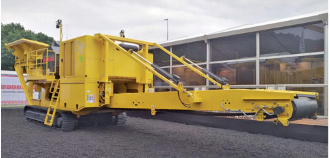
**K**eestrack ha presentado durante la celebración de Matexpo la trituradora de mandíbulas diésel B3e, una variante híbrida de su exitoso modelo desplegado en obras y reciclaje. En ella se conservan todas las ventajas específicas de la máquina de 30 toneladas montada sobre orugas.
