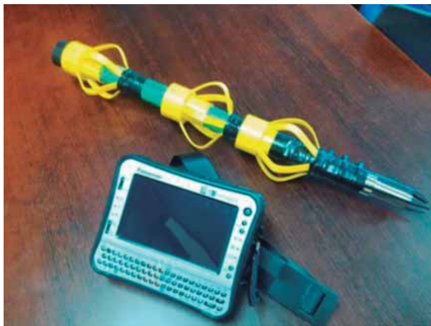
Figura 2. Sistema Riosensor de medición de la desviación.
