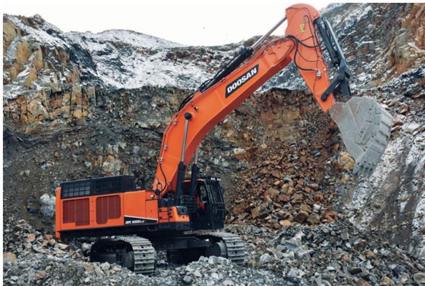
de un sistema hidráulico de centro cerrado para optimizar la productividad y el consumo de combustible, dependiendo del modo seleccionado. Una válvula de control principal de centro cerrado minimiza las pérdidas de presión, al tiempo que la bomba con regulación electrónica por presión gestiona y optimiza la potencia del motor con mayor eficacia.
