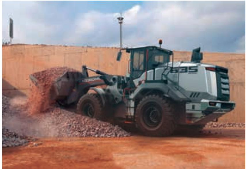
con su cabina ergonómica para el operador que cuenta con certificados ROPS / FOPS. Con calefacción en los asientos, cámara de marcha atrás, pantalla táctil, espejo con control eléctrico y calefacción, la HMK 635 WL ofrece un alto nivel de confort.
