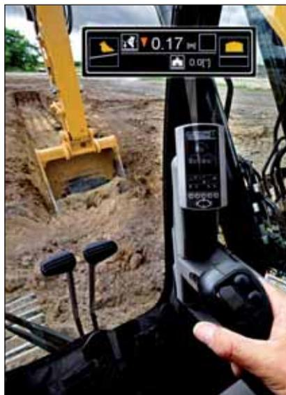
corte, una función de protección de pendiente evita que la cuchilla penetre por debajo del nivel de la pendiente, lo que permite a los contratistas ahorrar tiempo y costes de repeticiones del trabajo, combustible, comprobación de pendientes, mano de obra y material de relleno.
