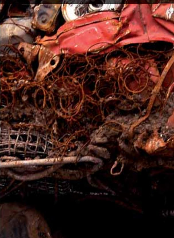
**H**oy en día la mayor parte de la chatarra procede de aquellos productos que han alcanzado el final de sus vidas útiles. Esta chatarra es una mezcla heterogénea y no puede utilizarse sin una importante transformación, que se concreta en dos operaciones fundamentales: la recuperación de la chatarra y la preparación para su adecuado reciclaje.
