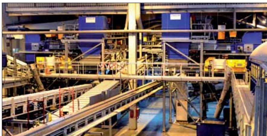
cascada de ópticos de recirculación, en la que primeramente se sopla, mediante un AUTOSORT de ancho 2.000 mm, todo lo valorizable remanente en este flujo (PET, PEAD, Brik, aluminio, férrico y papel-cartón). De aquí surgen dos flujos:
