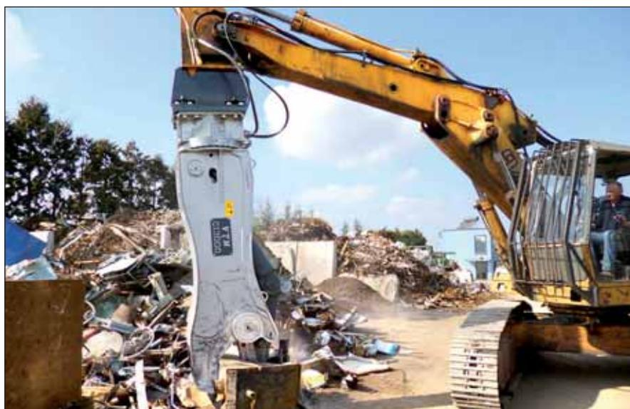
las aplicaciones más pesados, con un conjunto giratorio que permite que el equipo se mantenga en la posición correcta. Equipado de serie con válvula de velocidad que reduce los tiempos de ciclo, cuchillas con perfil trapezoidal que mejoran la línea de corte, y un kit de ajuste innovador sobre las mordazas para ajustar las holguras, sin necesidad de intervención manual, las cizallas VTN son extremadamente versátiles y adecuados para la mayoría aplicaciones específicas.
