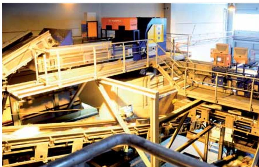
genera un nuevo punto de selección de la fracción Mix (soplado del primer óptico de recirculación y soplado de la fracción Mix en el segundo), ya que la existencia de papel cartón en la fracción rodante cuando se procesan Envases Ligeros es tan pequeña que se selecciona mediante triaje manual en la cabina de control de calidad previa a la cascada de recirculación”.
