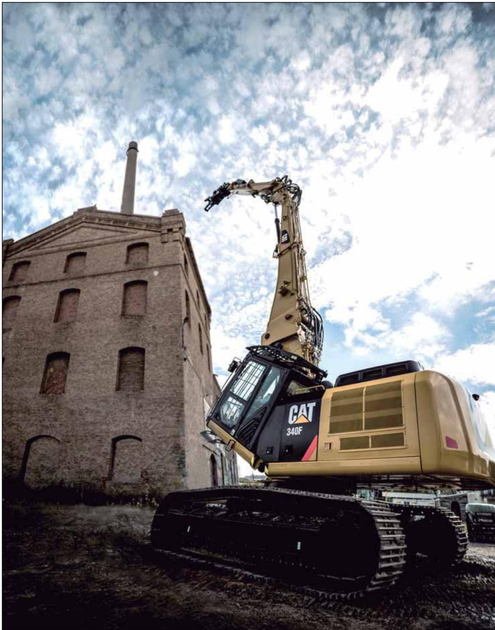
Caterpillar ha aprovechado su presencia en DDR Expo & Forum 2017 para presentar la excavadora hidráulica 340F UHD. La nueva máquina UHD puede alcanzar hasta 22 m de altura del bulón vertical, con una capacidad para un máximo de 3,6 toneladas y un alcance horizontal máximo de 14 m.
