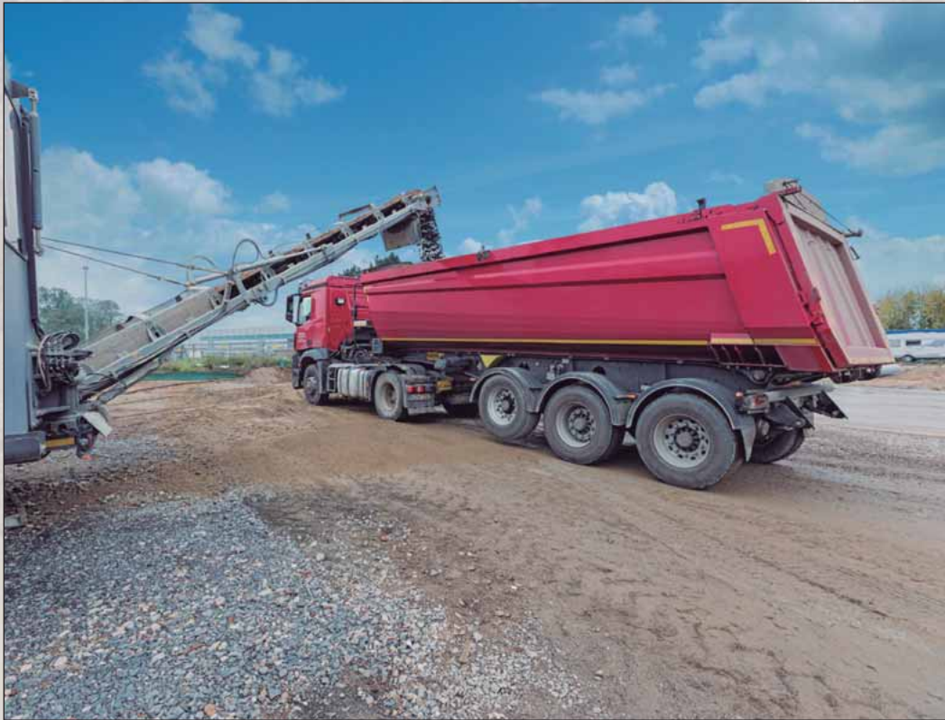
La cinta de descarga girable de la mezcladora móvil de reciclaje en frío KMA 220 de Wirtgen permite el llenado completo de camiones y un transporte sin problemas, incluso a plena carga.
