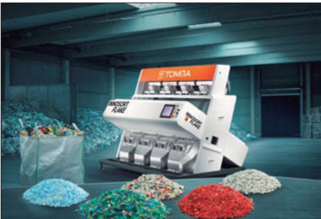
2 metros. Y para ofrecer un excelente rendimiento utiliza la tecnología Flying Beam de infrarrojo cercano (NIR), específica para escamas de PO, así como una cámara dual a todo color. La Flying Beam es la única tecnología NIR del mercado que permite una corrección automática y continua de la señal asegurando así los resultados de clasificación más estables y fiables, junto con un mantenimiento y el consumo de energía más bajos del mercado.
