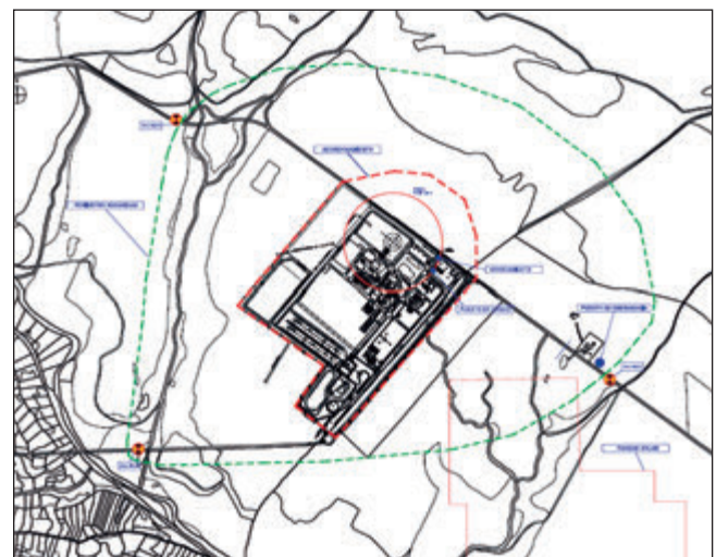
Perímetro de seguridad definido para el disparo de la voladura
