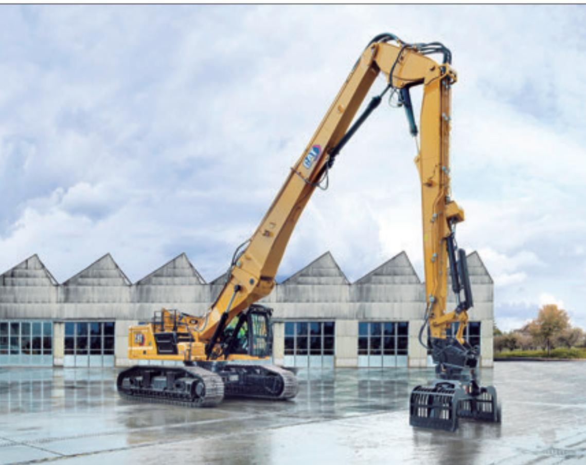
tren de rodaje fijo tiene una altura de transporte reducida de 3403 mm, una reducción de 117 mm en comparación con la serie F anterior.
