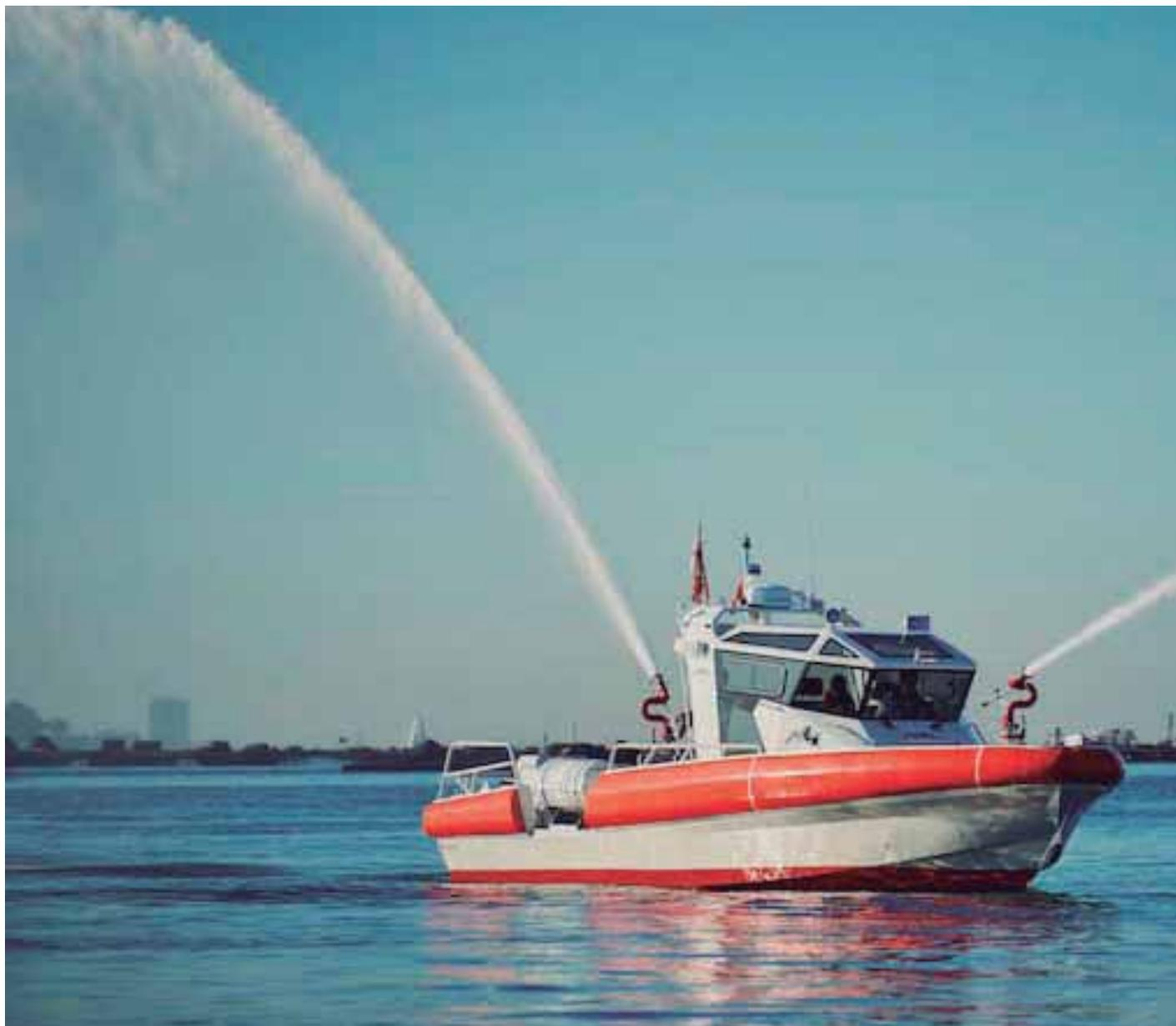
**L**a embarcación tiene una eslora de casco de 10 metros y una eslora total de 11 metros. El casco, construido en aluminio marino, cuenta con una defensa de contorno rígido de espuma de celda cerrada, polietileno, recubierto de una piel plástica, poliuretano, lo que confiere a la defensa una mayor robustez. Esta defensa tiene una forma evolutiva que desde Aister se ha diseñado en específico para esta embarcación ante las necesidades del armador.
