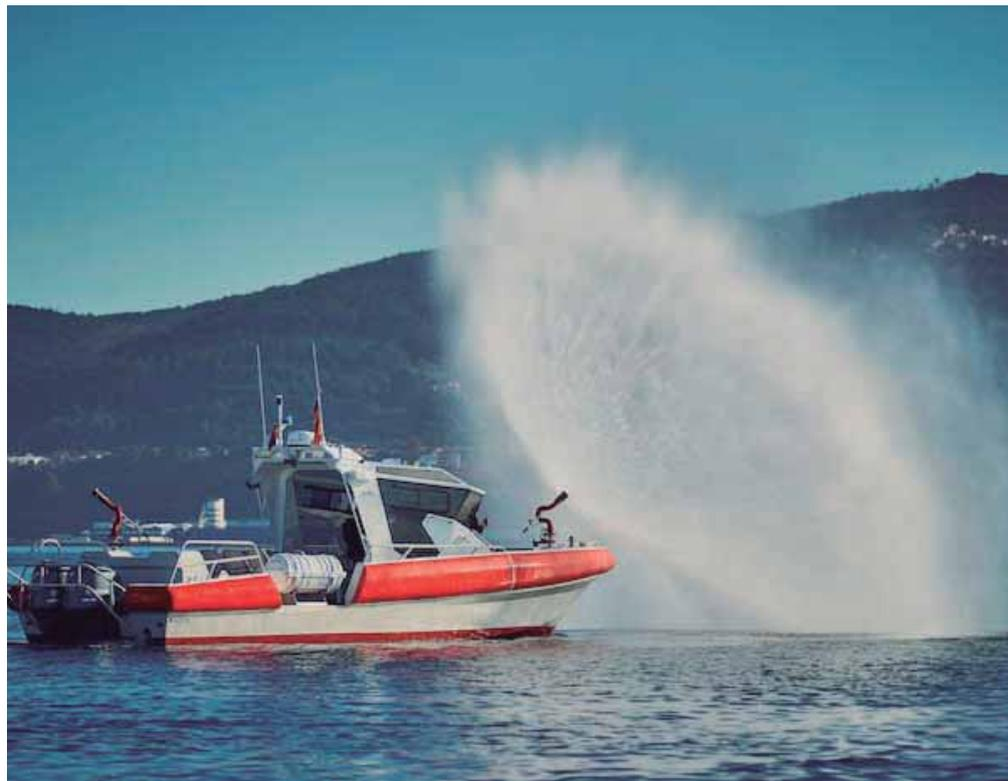
traincendios, que consiste en una motobomba que trabaja para dos monitores, uno a popa y otro a proa. La motobomba diésel se sitúa en el compartimento de popa con una capacidad 240 metros cúbicos por hora, lo que equivale a 4000 litros por minuto. El sistema de start-stop se controla desde la cabina de gobierno, pero los monitores se operan manualmente. Pueden usarse tanto individualmente como simultáneamente sin afectar a la operativa.
