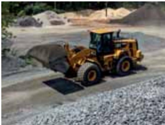
tándar se entrega de fábrica con el sistema Cat Production Measurement preinstalado. La versión 1.2 del sistema indica ahora si el varillaje se encuentra dentro del rango de peso, lo que permite a los operadores confirmar que los pesajes en básculas son precisos. El sistema también permite que los operadores activen manualmente la función de descarga parcial para las aplicaciones en las que la detección "automática" de la carga parcial no es la solución ideal.
