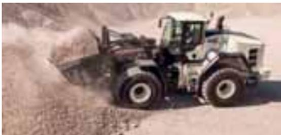
En la última edición de Bauma, Hidromek presentó al mercado un nuevo modelo de cargadora articulada de 24 toneladas de peso operativo que cuenta con una cuchara de 4 m<sup>3</sup> de capacidad. Esta máquina equipa un motor turbodiesel de 324 HP y seis cilindros fabricado por Mercedes y adaptado al sector industrial por MTU.
