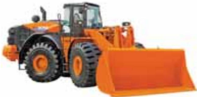
Montan un motor Deutz con tecnología common rail Etapa IIIB (acorde a la legislación vigente de emisiones para esta categoría) con tratamiento de gases de escape compuesto por el sistema EGR (recirculación de gases de escape) refrigerado y catalizador de oxidación (DOC). El mantenimiento es cada 500 horas y el acceso a los distintos componentes es sencillo gracias a su capó de fácil apertura.
