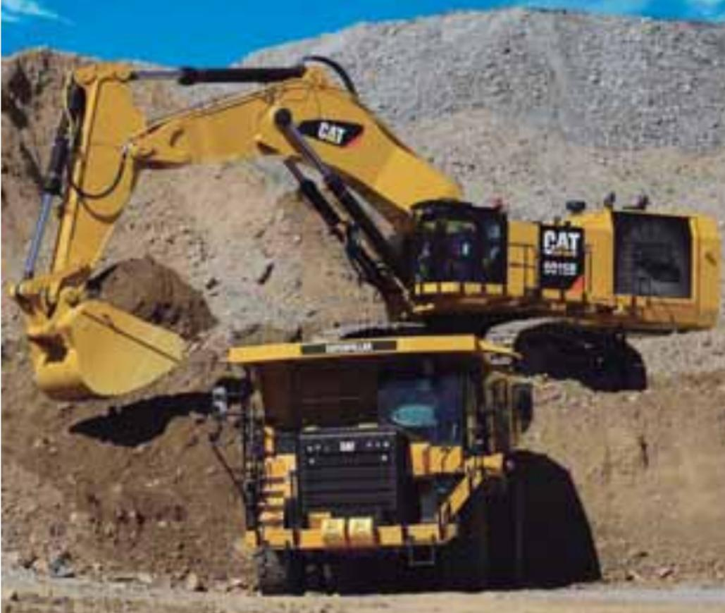
140 Toneladas de masa; 813hp de potencia y 8,1 m<sup>3</sup> de capacidad de cucharón para obtener ...
