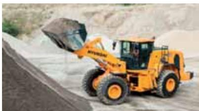
mejorada, con una capacidad de carga axial máxima es de 44.000 kg en la parte delantera y de 35.000 kg en la parte trasera, con neumáticos 23.5 R25 L3.
