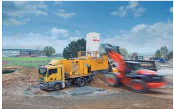
La longitud de transporte de la KMA 220 de Wirtgen, incluida la cabina, es de 14,71 m. La anchura de transporte es de solo 2,50 m, ya que la cabina se pliega para el transporte.
