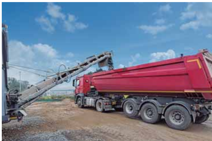
La cinta de descarga girable de la mezcladora móvil de reciclaje en frío KMA 220 de Wirtgen permite el llenado completo de camiones y un transporte sin problemas, incluso a plena carga.
