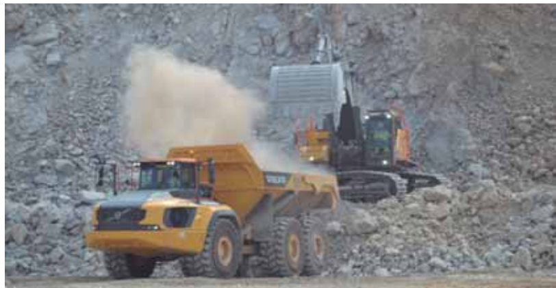
7 ciclos y 2 minutos de tiempo tarda la excavadora EC750E en cargar el dúmper A60H.
