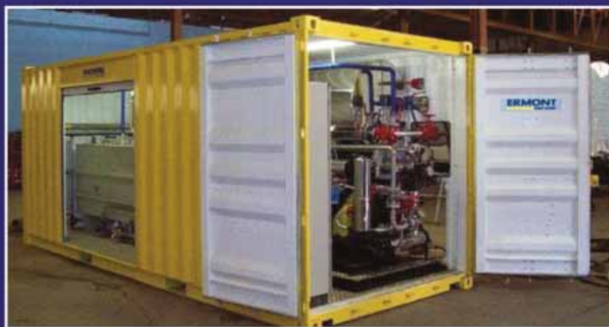
PLANTA DE EMULSIÓN
