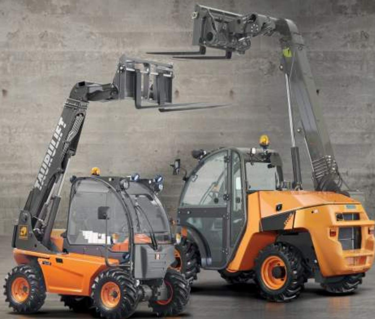
El brazo lateral dota al manipulador telescópico de unas reducidas dimensiones en altura y consigue un mejor manejo sin renunciar a una cabina espaciosa y confortable. Además, su posición sobre el eje delantero proporciona una mejor visibilidad al conductor y una mayor seguridad durante las operaciones de carga y descarga.
