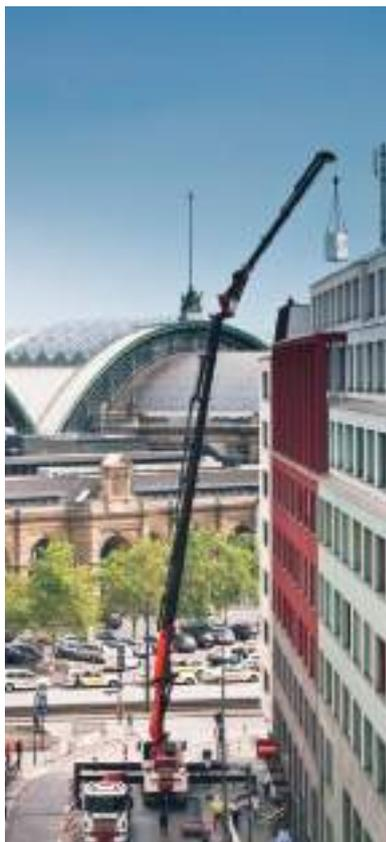
de instalación de solo 3.8 metros en un chasis de camión convencional de 8x4. Por supuesto, los alcances como estos también requieren un sofisticado concepto de estabilizador que es completamente monitoreado por sensores y estabilizadores delanteros y traseros adicionales, todos los cuales pueden ser controlados remotamente por el operador desde su mando Palcom P7.
