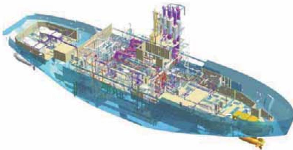
Modelo 3D de maquinaria, tuberías y accesorios del rompehielos NB510 de Arctech.
