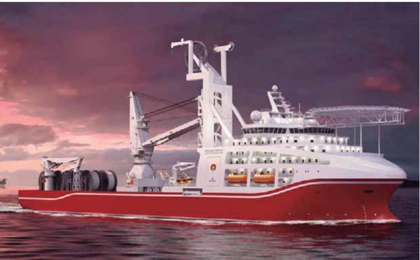
**E**l buque que operará la Oficina Estatal de Salvamento de Shangai realizará operaciones de salvamento en aguas profundas (6.000 m), de colocación de tubos, de construcción en aguas profundas, y las operaciones de buceo de saturación (SAT). El buceo SAT es una técnica que permite a los buzos reducir el riesgo de descompresión cuando se trabaja a grandes profundidades durante períodos prolongados de tiempo.
