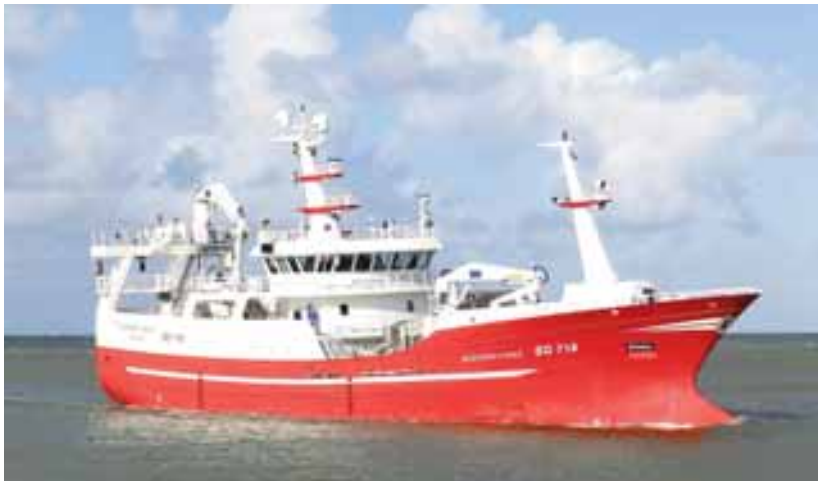
Arrastrero "Western Viking", del armador irlandés Frank Doherty, propulsado con el motor 9L27/38.
