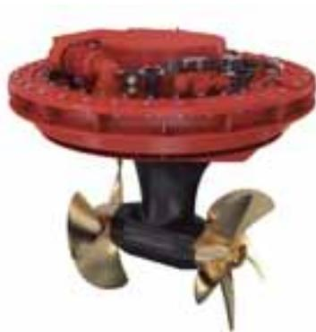
La hélice azimutal de Veth Propulsion, L-Drive Integrada, se caracteriza por su mínimo empaque, bajo ruido generado y gran rendimiento, siendo actualmente el propulsor eléctrico muy compacto.
