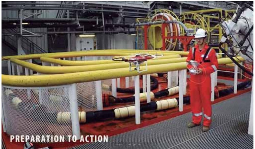
no, el viento es el mayor factor de riesgo. Elegimos el dron DJI Phantom para el estudio “Safe Escandinavia”, ya que se puede equipar con una jaula. Proteger el dron ha sido importante, ya que se operó cerca de obstáculos como cadenas de anclaje y cables. Lo mejor de DJI Phantom es su tamaño compacto. Se adapta a una mochila, por lo que es conveniente llevarlo a la costa en helicóptero”.
