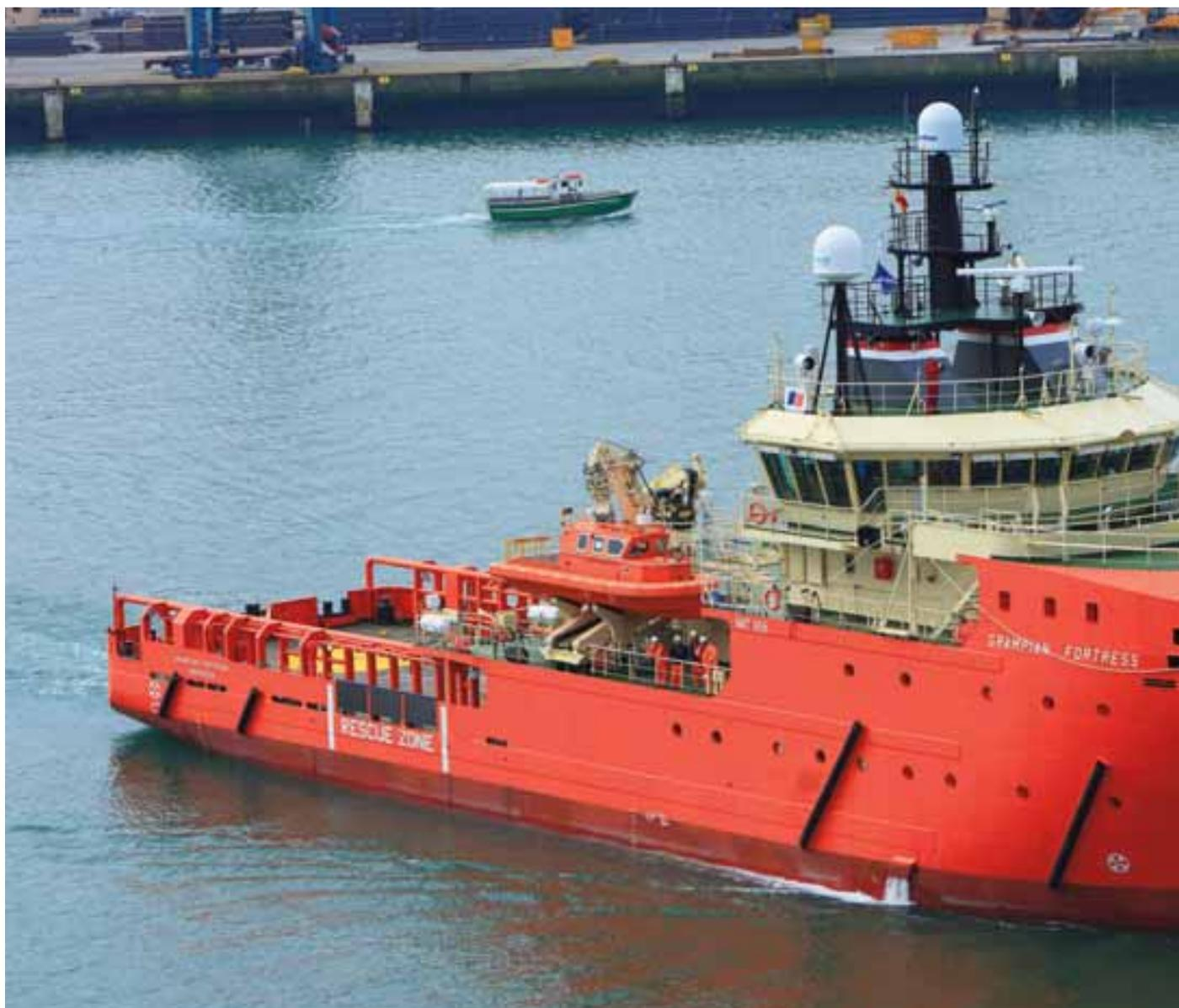
una manga de 13,2m, representa una evolución en el diseño IMT950 anterior, con un sistema de propulsión diesel-eléctrica y funciones adicionales de carga y capacidad.
