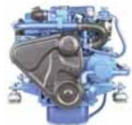
Ambos motores son sobrealimentados con un turbocompresor, que les permite desarrollar una mayor potencia y mantener la misma cilindrada.
