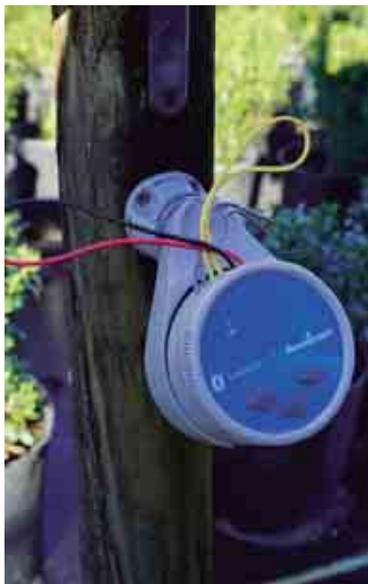
El nuevo programador a pilas Sennode-BT de Senninger posibilita la sencilla gestión del riego desde la palma de la mano, mediante el móvil, a través de Bluetooth.
