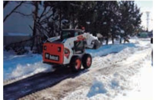
recondicionar las pistas y las instalaciones del aeropuerto. Una de las funciones especiales de las máquinas Bobcat es la limpieza de los alledaños de los aviones que para poder salir de los fingers es necesario que esté totalmente limpio de nieve, esto es posible gracias a las cargadoras Bobcat por su compacidad y su rapidez en lugares estrechos. ●
