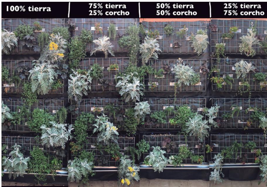
FOTO 2: Cubierta verde vertical de JOGOSA en Badajoz. Arriba los tratamientos ensayados.
