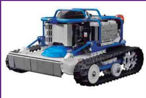
Desbrozadora radio-control sobre orugas para la siega sobre terrenos de gran inclinación, áreas extensas, de difícil acceso y gran cantidad de maleza.
