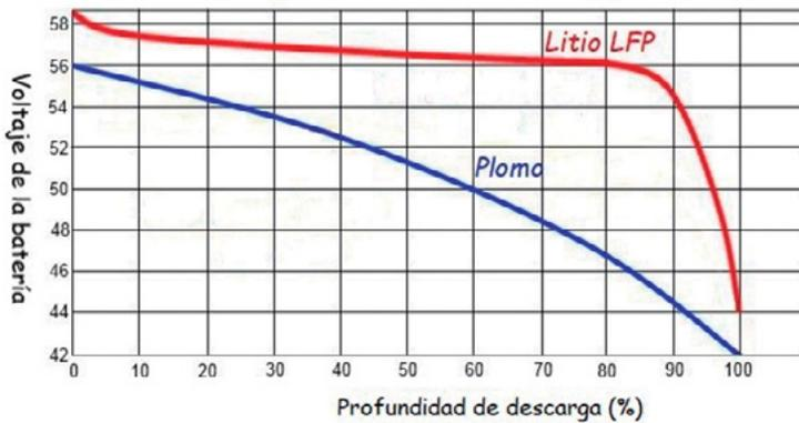
te un control equilibrado del voltaje de las celdas, proporcionando mayor durabilidad y por ende permitiendo al fabricante ofrecer 5 años de garantía sin límite de amperios consumidos. Todo esto, unido al eficiente funcionamiento del sistema de frenado Intellibrake, (presente en toda la gama RXV) hace que los costes operativos y de mantenimiento sean realmente bajos. Con este sistema devolveremos ener-
