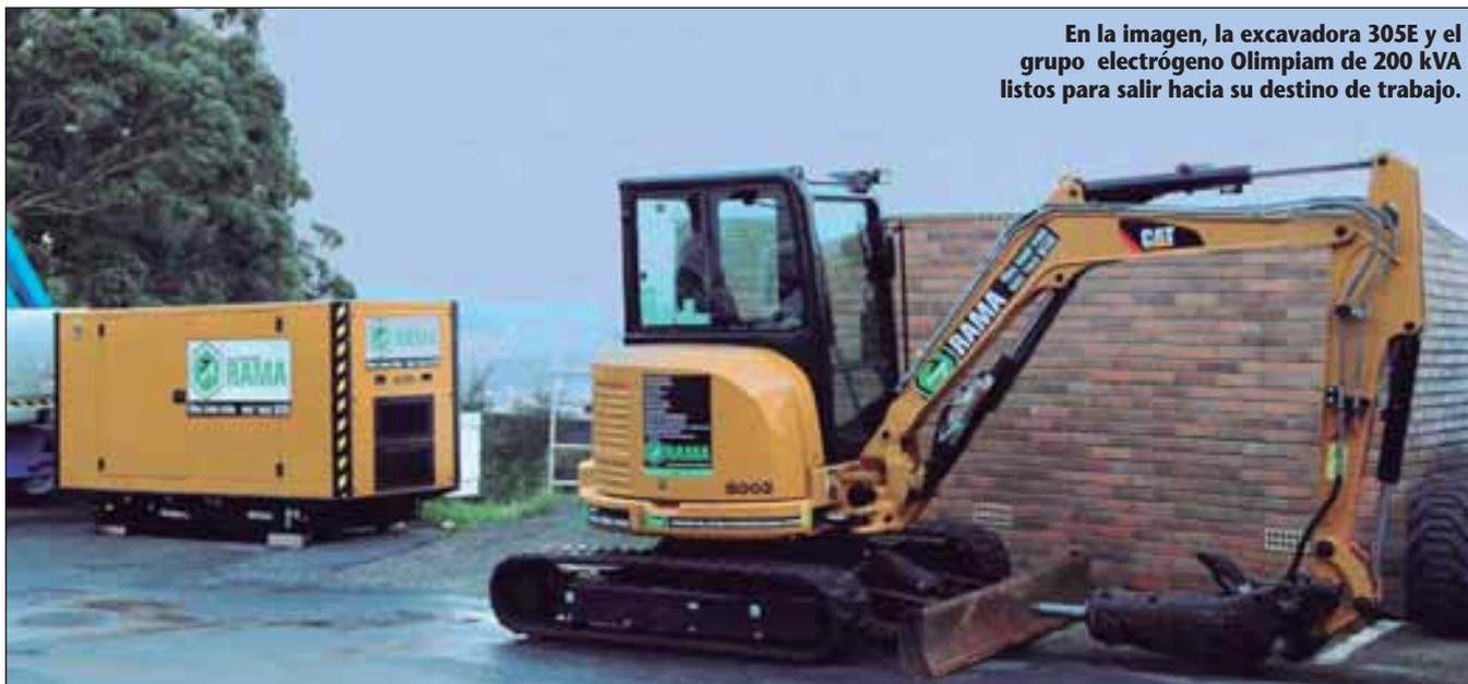
En la imagen, la excavadora 305E y el grupo electrógeno Olimpiam de 200 kVA listos para salir hacia su destino de trabajo.
