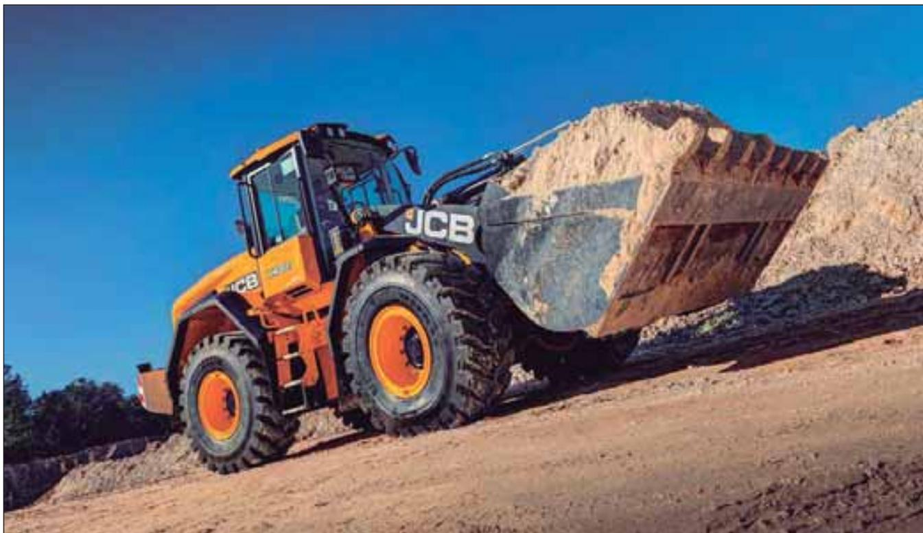
la 411 y unos potentes 108 kW (125 CV) en la 417. Las cargadoras más grandes 427 y 437 funcionan con un motor diésel Cummins Tier 4 Final/Fase IV, que ofrece 133 kW (179 CV) y 136 kW (183 CV) respectivamente.
