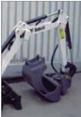
co que puede funcionar con baterías recargables de ion-litio o con suministro de corriente eléctrica de 400 V por medio de un cable de alimentación eléctrico. Las baterías se cargan con rapidez (recarga total en menos de una hora) y cuando están totalmente cargadas, la excavadora puede funcionar sin corriente eléctrica durante 2 o 3 horas. El nuevo modelo E10 Electric también ofrece la posibilidad de trabajar mientras se carga la batería mediante el uso de un cable de alimentación.
