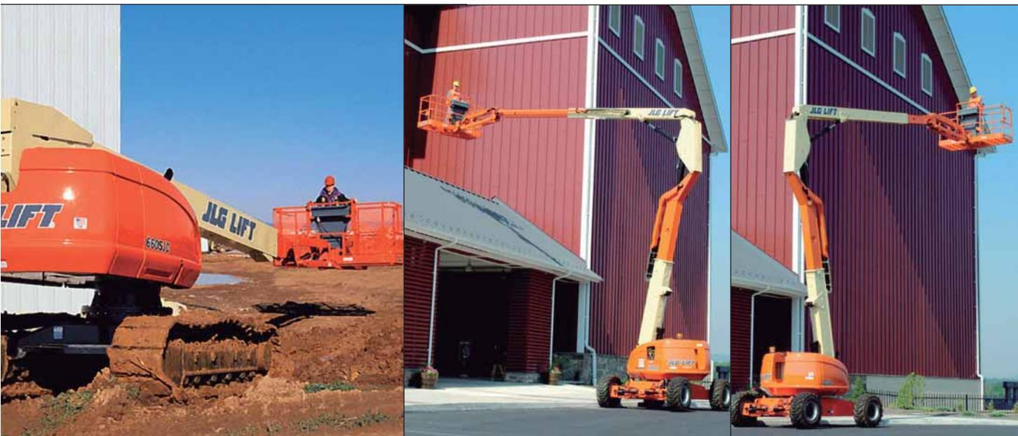
so contenido, el chasis estrecho y la tracción con el eje oscilante, aseguran el rápido posicionamiento de la plataforma en pendientes de 45%. Una contribución fundamental a la excelencia de rendimiento de estas dos series se debe al sistema de control ADE® (Advances Design Electronics), instalado en todos los modelos de nueva generación. Esto hace posible adaptar la velocidad, moverse con mayor agilidad y beneficiarse de un
