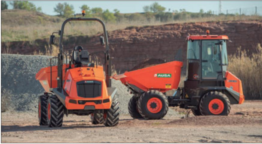
Equipa un pequeño pero ágil motor de cuatro cilindros Kubota de 18,5 kW, que cumple la normativa Stage V y tiene un par motor de 92,6@1700.
