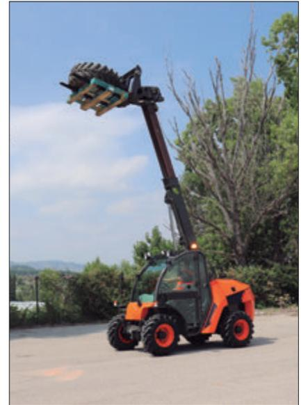
El T204H tiene una capacidad de carga de 2.000 kg y una elevación máxima de 4,2 metros. El T235H, por su parte, puede cargar hasta 2.300 kg con una elevación máxima de 5 metros. Ambos modelos comparten la misma plataforma y características. Como el motor Kubota de 32,5 kW de potencia.
