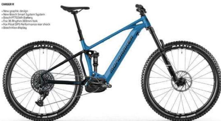
STEALTH ALLOY • BOSCH PERFORMANCE LINE CX G4 Smart System PT750WH • FOX 36 RHYTHM • FOX FLOAT DPS PERFORMANCE • MAVIC E-DEEMAX 29 • SRAM G2 R • SRAM GX
