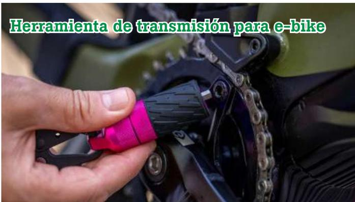
Si tienes una eBike sabrás que limpiar y engrasar tu cadena es un asunto complicado, ya que la biela no gira hacia atrás como en una bicicleta normal a menos que se le dé la vuelta. Pero esto puede rayar los componentes, o si utilizas una llave Allen en el tornillo de la biela, puede atascarse en el tornillo, o peor, dañar sus preciosas bielas. PVR: 24,95€
