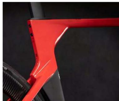
diseñado recurriendo a la dinámica de fluidos computacional y a los ensayos en túneles de viento reales. El resultado es una reducción del 30 % del rozamiento en un cuadro que cumple totalmente las normas de la UCI y que integra con
