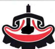
En condiciones sin aire, aún se puede rodar por un período limitado a 10 km/h sin dañar la llanta.
