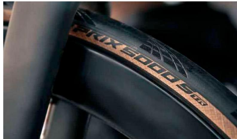
incluye un TPI de 3/330, más elevado, para mejora la flexibilidad y el funcionamiento estable a menor presión. Continental recomienda el uso de al menos 30 ml de líquido sellador en el interior del neumático para su montaje tubeless ready.
