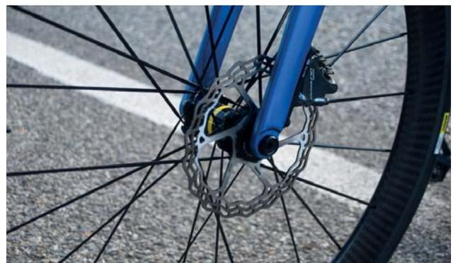
Uso de ruedas convencionales con frenos de disco y ejes pasantes, con posibilidad de montar neumáticos de 30 mm aportando comodidad y seguridad.
