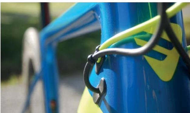
El aspecto Aero típico de BERRIA se ve en la tecnología Internal Cable System 2, con la integración total y muy limpia del cableado en el cuadro.
