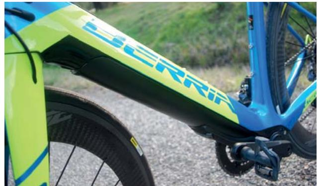
El sistema integrado Evation de Fazua es el más compacto y avanzado del mercado, con un peso de 4,70 kg, incluida la batería.
